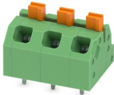
Leiterplattenklemme, Nennstrom: 16 A, Bemessungsspannung (III/2): 320 V, Nennquerschnitt: 1,5 mm<sup>2</sup>, Anzahl der Potenziale: 3, Anzahl der Reihen: 1, Polzahl pro Reihe: 3, Artikelfamilie: SPTAF 1/...-EL, Rastermaß: 5 mm, Anschlussart: Push-in-Federanschluss, Montage: Wellenlöten, Anschlussrichtung Leiter/Platine: 45 °, Farbe: grün, Pin-Layout: Lineares Pinning, Pinlänge [P]: 2,6 mm, Anzahl der Löt pins pro Potenzial: 2, Verpackungsart: verpackt im Karton
