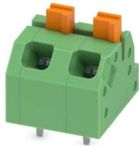
Leiterplattenklemme, Nennstrom: 16 A, Bemessungsspannung (III/2): 320 V, Nennquerschnitt: 1,5 mm<sup>2</sup>, Anzahl der Potenziale: 2, Anzahl der Reihen: 1, Polzahl pro Reihe: 2, Artikelfamilie: SPTAF 1/...-EL, Rastermaß: 5 mm, Anschlussart: Push-in-Federanschluss, Montage: Wellenlöten, Anschlussrichtung Leiter/Platine: 45 °, Farbe: grün, Pin-Layout: Lineares Pinning, Pinlänge [P]: 2,6 mm, Anzahl der Löt pins pro Potenzial: 2, Verpackungsart: verpackt im Karton
