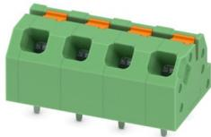
Leiterplattenklemme, Nennstrom: 16 A, Bemessungsspannung (III/2): 320 V, Nennquerschnitt: 1,5 mm<sup>2</sup>, Anzahl der Potenziale: 4, Anzahl der Reihen: 1, Polzahl pro Reihe: 4, Artikelfamilie: SPTAF 1/..-IL, Rastermaß: 5 mm, Anschlussart: Push-in-Federanschluss, Montage: Wellenlöten, Anschlussrichtung Leiter/Platine: 45 °, Farbe: grün, Pin-Layout: Lineares Pinning, Pinlänge [P]: 2,6 mm, Anzahl der Lötpins pro Potenzial: 2, Verpackungsart: verpackt im Karton. CAT 5 geeignet
