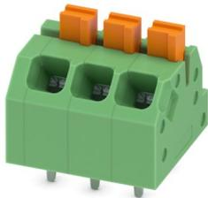
Leiterplattenklemme, Nennstrom: 16 A, Bemessungsspannung (III/2): 160 V, Nennquerschnitt: 1,5 mm<sup>2</sup>, Anzahl der Potenziale: 3, Anzahl der Reihen: 1, Polzahl pro Reihe: 3, Artikelfamilie: SPTAF 1/...-EL, Rastermaß: 3,5 mm, Anschlussart: Push-in-Federanschluss, Montage: Wellenlöten, Anschlussrichtung Leiter/Platine: 45 °, Farbe: grün, Pin-Layout: Lineares Pinning, Pinlänge [P]: 2,6 mm, Anzahl der Löt pins pro Potenzial: 2, Verpackungsart: verpackt im Karton
