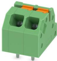
Leiterplattenklemme, Nennstrom: 16 A, Bemessungsspannung (III/2): 160 V, Nennquerschnitt: 1,5 mm<sup>2</sup>, Anzahl der Potenziale: 2, Anzahl der Reihen: 1, Polzahl pro Reihe: 2, Artikelfamilie: SPTAF 1/...-IL, Rastermaß: 3,5 mm, Anschlussart: Push-in-Federanschluss, Montage: Wellenlöten, Anschlussrichtung Leiter/Platine: 45 °, Farbe: grün, Pin-Layout: Lineares Pinning, Pinlänge [P]: 2,6 mm, Anzahl der Löt pins pro Potenzial: 2, Verpackungsart: Tray
