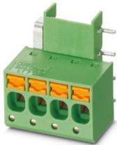
Leiterplattenklemme, Nennstrom: 20 A, Bemessungsspannung (III/2): 320 V, Nennquerschnitt: 2,5 mm<sup>2</sup>, Anzahl der Potenziale: 4, Anzahl der Reihen: 1, Polzahl pro Reihe: 4, Artikelfamilie: FKDSO 2,5/ ..R1, Rastermaß: 5 mm, Anschlussart: Push-in-Federanschluss, Montage: Wellenlöten, Anschlussrichtung Leiter/Platine: 0 °, Farbe: grün, Pin-Layout: Lineares Pinning, Pinlänge [P]: 3,5 mm, Anzahl der Lötpins pro Potenzial: 1, Verpackungsart: verpackt im Karton
