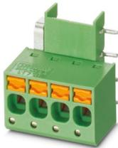
Leiterplattenklemme, Nennstrom: 20 A, Bemessungsspannung (III/2): 320 V, Nennquerschnitt: 2,5 mm<sup>2</sup>, Anzahl der Potenziale: 2, Anzahl der Reihen: 1, Polzahl pro Reihe: 2, Artikelfamilie: FKDSO 2,5/ ..R1, Rastermaß: 5 mm, Anschlussart: Push-in-Federanschluss, Montage: Wellenlöten, Anschlussrichtung Leiter/Platine: 0 °, Farbe: grün, Pin-Layout: Lineares Pinning, Pinlänge [P]: 3,5 mm, Anzahl der Lötpins pro Potenzial: 1, Verpackungsart: verpackt im Karton
