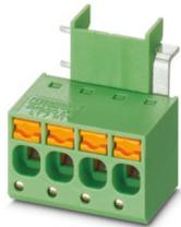
Leiterplattenklemme, Nennstrom: 20 A, Bemessungsspannung (III/2): 320 V, Nennquerschnitt: 2,5 mm<sup>2</sup>, Anzahl der Potenziale: 4, Anzahl der Reihen: 1, Polzahl pro Reihe: 4, Artikelfamilie: FKDSO 2,5/ ..-L1, Rastermaß: 5 mm, Anschlussart: Push-in-Federanschluss, Montage: Wellenlöten, Anschlussrichtung Leiter/Platine: 0 °, Farbe: grün, Pin-Layout: Lineares Pinning, Pinlänge [P]: 3,5 mm, Anzahl der Lötpins pro Potenzial: 1, Verpackungsart: verpackt im Karton
