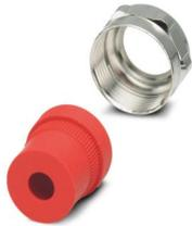
Halbverschraubung Pg21, aus Metall, bestehend aus Dichtgummi mit einer Bohrung und einer Druckschraube, für Gehäuse der Bauform 2 - 4, Kabel [mm] 9 - 13
