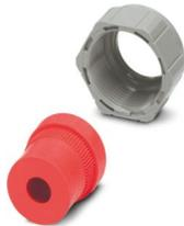
Halbverschraubung Pg21, aus Kunststoff, bestehend aus Dichtgummi mit einer Bohrung und einer Druckschraube, für Gehäuse der Bauform 2 - 4, Kabel [mm] 9 - 13
