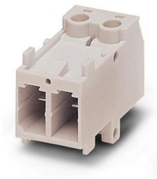
Kontakteinsatz, Artikelfamilie: VARIOCON, Farbe: lichtgrau, Polzahl: 2, Aderquerschnitt min.: 0,25 mm<sup>2</sup>, Aderquerschnitt max.: 4 mm<sup>2</sup>, Bemessungsspannung: 400, Bemessungsstrom: 20 A, Anschlussart: Schraubanschluss, Steckverbinder dürfen nur leistungslos betätigt werden.
