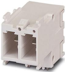
Kontakteinsatz, Artikelfamilie: VARIOCON, Farbe: lichtgrau, Polzahl: 2, Bemessungsspannung: 400, Bemessungsstrom: 20 A, Anschlussart: Leiterplattenanschluss, Steckverbinder dürfen nur leistungslos betätigt werden.
