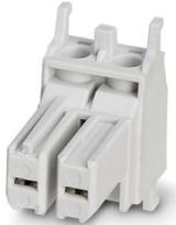
Kontakteinsatz, Artikelfamilie: VARIOCON, Farbe: lichtgrau, Polzahl: 2, Aderquerschnitt min.: 0,25 mm<sup>2</sup>, Aderquerschnitt max.: 4 mm<sup>2</sup>, Bemessungsspannung: 400, Bemessungsstrom: 20 A, Anschlussart: Schraubanschluss, Steckverbinder dürfen nur leistungslos betätigt werden.
