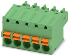
Leiterplattenstecker, Nennquerschnitt: 1,5 mm<sup>2</sup>, Farbe: grün, Nennstrom: 8 A, Bemessungsspannung (III/2): 160 V, Kontaktoberfläche: Sn, Kontaktart: Buchse, Anzahl der Potenziale: 5, Anzahl der Reihen: 1, Polzahl: 5, Anzahl der Anschlüsse: 5, Artikelfamilie: FK-MCP 1,5/...-ST, Rastermaß: 3,81 mm, Anschlussart: Push-in-Federanschluss, Anschlussrichtung Leiter/Platine: 0 °, Stecksystem: COMBICON MC 1,5, Verriegelung: ohne, Befestigungsart: ohne, Verpackungsart: verpackt im Karton
