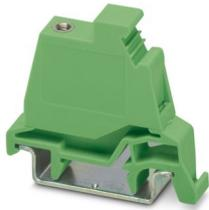
Flanschklamme, wird links und rechts an PCVK 4-7,62 gereiht, zur sicheren Verschraubung von Steckern mit Schraubflansch, Raster: 7,62 mm, Farbe: grün
