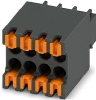
Leiterplattenstecker, Nennquerschnitt: 0,5 mm<sup>2</sup>, Farbe: schwarz, Nennstrom: 6 A, Bemessungsspannung (III/2): 160 V, Kontaktoberfläche: Au, Kontaktart: Buchse, Anzahl der Potenziale: 8, Anzahl der Reihen: 2, Polzahl: 4, Anzahl der Anschlüsse: 8, Artikelfamilie: DFMC 0,5/..-ST, Rastermaß: 2,54 mm, Anschlussart: Push-in-Federanschluss, Anschlussrichtung Leiter/Platine: 0 °, Stecksystem: COMBICON DFMC 0,5, Verriegelung: ohne, Befestigungsart: ohne, Verpackungsart: verpackt im Karton
