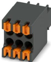
Leiterplattenstecker, Nennquerschnitt: 0,5 mm<sup>2</sup>, Farbe: schwarz, Nennstrom: 6 A, Bemessungsspannung (III/2): 160 V, Kontaktoberfläche: Au, Kontaktart: Buchse, Anzahl der Potenziale: 6, Anzahl der Reihen: 2, Polzahl: 3, Anzahl der Anschlüsse: 6, Artikelfamilie: DFMC 0,5/..-ST, Rastermaß: 2,54 mm, Anschlussart: Push-in-Federanschluss, Anschlussrichtung Leiter/Platine: 0 °, Stecksystem: COMBICON DFMC 0,5, Verriegelung: ohne, Befestigungsart: ohne, Verpackungsart: verpackt im Karton
