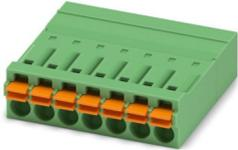
Leiterplattenstecker, Nennquerschnitt: 1,5 mm<sup>2</sup>, Farbe: grün, Nennstrom: 8 A, Bemessungsspannung (III/2): 160 V, Kontaktoberfläche: Sn, Kontaktart: Stift, Anzahl der Potenziale: 7, Anzahl der Reihen: 1, Polzahl: 7, Anzahl der Anschlüsse: 7, Artikelfamilie: IFMC 1,5/..-ST, Rastermaß: 3,5 mm, Anschlussart: Push-in-Federanschluss, Anschlussrichtung Leiter/Platine: 0 °, Stecksystem: COMBICON MC 1,5, Verriegelung: ohne, Befestigungsart: ohne, Verpackungsart: verpackt im Karton
