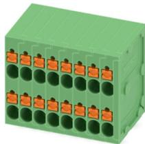
Leiterplattenklemme, Nennstrom: 10 A, Bemessungsspannung (III/2): 200 V, Nennquerschnitt: 1,5 mm<sup>2</sup>, Anzahl der Potenziale: 16, Anzahl der Reihen: 2, Polzahl pro Reihe: 8, Artikelfamilie: SPTD 1,5, Rastermaß: 3,5 mm, Anschlussart: Push-in-Federanschluss, Montage: Wellenlöten, Anschlussrichtung Leiter/Platine: 0 °, Farbe: grün, Pin-Layout: Lineares Pinning, Pinlänge [P]: 3,5 mm, Anzahl der Lötpins pro Potenzial: 1, Verpackungsart: verpackt im Karton
