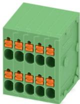
Leiterplattenklemme, Nennstrom: 10 A, Bemessungsspannung (III/2): 200 V, Nennquerschnitt: 1,5 mm<sup>2</sup>, Anzahl der Potenziale: 10, Anzahl der Reihen: 2, Polzahl pro Reihe: 5, Artikelfamilie: SPTD 1,5, Rastermaß: 3,5 mm, Anschlussart: Push-in-Federanschluss, Montage: Wellenlöten, Anschlussrichtung Leiter/Platine: 0 °, Farbe: grün, Pin-Layout: Lineares Pinning, Pinlänge [P]: 3,5 mm, Anzahl der Lötpins pro Potenzial: 1, Verpackungsart: verpackt im Karton
