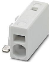
Leiterplattenklemme, Nennstrom: 6 A, Bemessungsspannung (III/2): 160 V, Nennquerschnitt: 0,5 mm<sup>2</sup>, Anzahl der Potenziale: 1, Anzahl der Reihen: 1, Polzahl pro Reihe: 1, Artikelfamilie: PTSM 0,5/...-H-SMD WH, Rastermaß: 2,5 mm, Anschlussart: Push-in-Federanschluss, Montage: SMD-Löten, Anschlussrichtung Leiter/Platine: 0 °, Farbe: signalweiß, Pin-Layout: Lineare Pad-Geometrie, Anzahl der Lötpins pro Potenzial: 1, Verpackungsart: Gurt in 24 mm Breite
