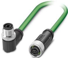
Netzwirkabel, 2-polig, PUR halogenfrei, grün, Stecker gewinkelt M12-SPE / IP67, auf Buchse gerade M12-SPE / IP67, Kabellänge: 10 m
