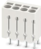
Leiterplattenklemme, Nennstrom: 6 A, Bemessungsspannung (III/2): 160 V, Nennquerschnitt: 0,5 mm<sup>2</sup>, Anzahl der Potenziale: 4, Anzahl der Reihen: 1, Polzahl pro Reihe: 4, Artikelfamilie: PTSM 0,5/...-V-THR WH, Rastermaß: 2,5 mm, Anschlussart: Push-in-Federanschluss, Montage: THR-Löten / Wellenlöten, Anschlussrichtung Leiter/Platine: 90 °, Farbe: signalweiß, Pin-Layout: Lineares Pinning, Pinlänge [P]: 2,1 mm, Anzahl der Löt pins pro Potenzial: 2, Verpackungsart: Gurt in 44 mm Breite
