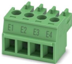
Leiterplattenstecker, Nennquerschnitt: 1,5 mm<sup>2</sup>, Farbe: grün, Nennstrom: 8 A, Bemessungsspannung (III/2): 160 V, Kontaktoberfläche: Sn, Kontaktart: Buchse, Anzahl der Reihen: 1, Polzahl: 4, Artikelfamilie: MC 1,5/..-ST, Rastermaß: 3,81 mm, Anschlussart: Schraubanschluss mit Zughülse, Schraubenangriffsform: L Längsschlitz, Anschlussrichtung Leiter/Platine: 0 °, Stecksystem: COMBICON MC 1,5, Verriegelung: ohne, Befestigungsart: ohne, Verpackungsart: verpackt im Karton
