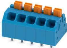
Leiterplattenklemme, Nennstrom: 16 A, Bemessungsspannung (III/2): 160 V, Nennquerschnitt: 1,5 mm<sup>2</sup>, Anzahl der Reihen: 1, Polzahl pro Reihe: 5, Artikelfamilie: SPTAF 1/..-EL, Rastermaß: 3,5 mm, Anschlussart: Push-in-Federanschluss, Montage: Wellenlöten, Anschlussrichtung Leiter/Platine: 45 °, Farbe: blau, Pin-Layout: Lineares Pinning, Pinlänge [P]: 2,6 mm, Anzahl der Löt pins pro Potenzial: 2, Verpackungsart: verpackt im Karton
