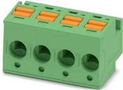
Leiterplattenstecker, Nennquerschnitt: 1,5 mm<sup>2</sup>, Farbe: grün, Nennstrom: 10 A, Bemessungsspannung (III/2): 400 V, Kontaktoberfläche: Sn, Kontaktart: Buchse, Anzahl der Potenziale: 4, Anzahl der Reihen: 1, Polzahl: 4, Anzahl der Anschlüsse: 4, Artikelfamilie: PTS 1,5/..-PH, Rastermaß: 5 mm, Anschlussart: Push-in-Federanschluss, Anschlussrichtung Leiter/Platine: 0 °, Stecksystem: COMBICON PST 1,3, Verriegelung: ohne, Befestigungsart: ohne, Verpackungsart: verpackt im Karton
