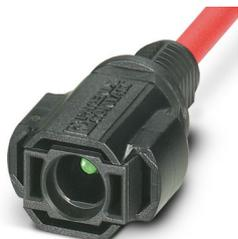
Gerätesteckverbinder Vorderwand, Artikelfamilie: SUNCLIX, Farbe: schwarz, Polzahl: 1, Aderquerschnitt min.: 4 mm<sup>2</sup>, Bemessungsstrom: 35 A, Anschlussart: Crimp, Kabellänge: 130
