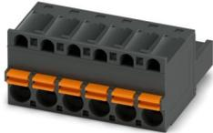
Leiterplattenstecker, Nennquerschnitt: 2,5 mm<sup>2</sup>, Farbe: schwarz, Nennstrom: 12 A, Bemessungsspannung (III/2): 320 V, Kontaktoberfläche: Sn, Kontaktart: Buchse, Anzahl der Reihen: 1, Polzahl: 6, Artikelfamilie: FKC 2,5/..-ST, Rastermaß: 5 mm, Anschlussart: Push-in-Federanschluss, Anschlussrichtung Leiter/Platine: 0 °, Rasthaken: - Rasthaken, Stecksystem: COMBICON MSTB 2,5, Verriegelung: ohne, Befestigungsart: ohne, Verpackungsart: verpackt im Karton
