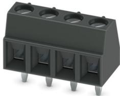
Leiterplattenklemme, Nennstrom: 17,5 A, Bemessungsspannung (III/2): 200 V, Nennquerschnitt: 1,5 mm<sup>2</sup>, Anzahl der Reihen: 1, Polzahl pro Reihe: 4, Artikelfamilie: MKDS 1, Rastermaß: 3,81 mm, Anschlussart: Schraubanschluss mit Zughülse, Schraubenangriffsform: L Längsschlitz, Montage: Wellenlöten, Anschlussrichtung Leiter/Platine: 0 °, Farbe: schwarz, Pin-Layout: Lineares Pinning, Pinlänge [P]: 3,5 mm, Anzahl der Lötpins pro Potenzial: 1, Verpackungsart: verpackt im Karton
