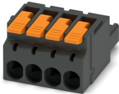
Leiterplattenstecker, Nennquerschnitt: 2,5 mm<sup>2</sup>, Farbe: schwarz, Nennstrom: 16 A, Bemessungsspannung (III/2): 320 V, Kontaktoberfläche: Sn, Kontaktart: Buchse, Anzahl der Reihen: 1, Polzahl: 4, Artikelfamilie: LPC 2,5/..-ST, Rastermaß: 5,08 mm, Anschlussart: Hebel-Push-in-Anschluss, Anschlussrichtung Leiter/Platine: 0 °, Rasthaken: - Rasthaken, Stecksystem: COMBICON MSTB 2,5, Verriegelung: ohne, Befestigungsart: ohne, Verpackungsart: verpackt im Karton
