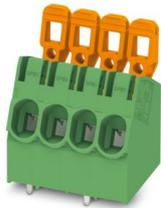
Leiterplattenklemme, Nennstrom: 41 A, Bemessungsspannung (III/2): 1000 V, Nennquerschnitt: 6 mm<sup>2</sup>, Anzahl der Potenziale: 7, Anzahl der Reihen: 1, Polzahl pro Reihe: 7, Artikelfamilie: PLA 5/, Rastermaß: 7,5 mm, Anschlussart: Push-Lock-Federanschluss, Montage: Wellenlöten, Anschlussrichtung Leiter/Platine: 30 °, Farbe: grün, Pin-Layout: Zick-Zack-Pinning M, Pinlänge [P]: 3,6 mm, Anzahl der Lötpins pro Potenzial: 1, Verpackungsart: verpackt im Karton
