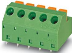
Leiterplattenklemme, Nennstrom: 12 A, Bemessungsspannung (III/2): 320 V, Nennquerschnitt: 1 mm<sup>2</sup>, Anzahl der Potenziale: 3, Anzahl der Reihen: 1, Polzahl pro Reihe: 3, Artikelfamilie: MFKDSP, Rastermaß: 5,08 mm, Anschlussart: Push-in-Federanschluss, Montage: Wellenlöten, Anschlussrichtung Leiter/Platine: 45 °, Farbe: grün, Pin-Layout: Lineares Pinning, Pinlänge [P]: 3,3 mm, Anzahl der Lötpins pro Potenzial: 2, Verpackungsart: verpackt im Karton
