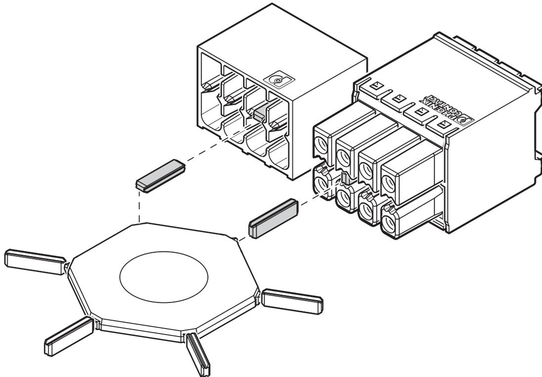
Anwendung des Kodierprofils CP-DMC...
