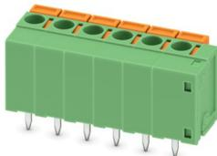
Leiterplattenklemme, Nennstrom: 15 A, Bemessungsspannung (III/2): 400 V, Nennquerschnitt: 1,5 mm<sup>2</sup>, Anzahl der Potenziale: 6, Anzahl der Reihen: 1, Polzahl pro Reihe: 6, Artikelfamilie: FFKDS(A)/V1, Rastermaß: 5,08 mm, Anschlussart: Push-in-Federanschluss, Montage: Wellenlöten, Anschlussrichtung Leiter/Platine: 90 °, Farbe: grün, Pin-Layout: Lineares Pinning, Pinlänge [P]: 3,4 mm, Anzahl der Lötpins pro Potenzial: 2, Verpackungsart: verpackt im Karton
