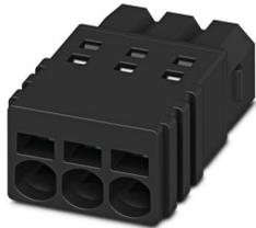
Leiterplattenstecker, Nennquerschnitt: 0,5 mm<sup>2</sup>, Farbe: schwarz, Nennstrom: 6 A, Bemessungsspannung (III/2): 160 V, Kontaktoberfläche: Sn, Kontaktart: Buchse, Anzahl der Potenziale: 5, Anzahl der Reihen: 1, Polzahl: 5, Anzahl der Anschlüsse: 5, Artikelfamilie: PTSM 0,5/...-P, Rastermaß: 2,5 mm, Anschlussart: Push-in-Federanschluss, Anschlussrichtung Leiter/Platine: 0 °, Stecksystem: COMBICON PTSM, Verriegelung: ohne, Befestigungsart: ohne, Verpackungsart: verpackt im Karton
