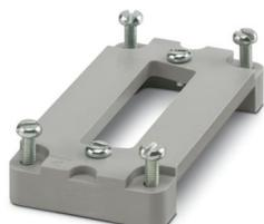
D-SUB-Adapterplatte, zur Bestückung mit einem D-SUB-Stecker, Polzahl 37, Gehäusebaureihe HC-B 16...
