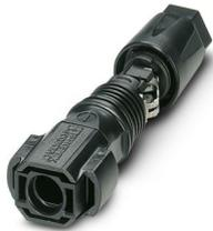
Steckverbinder, Artikelfamilie: SUNCLIX, Farbe: schwarz, Polzahl: 1, Aderquerschnitt min.: 2,5 mm<sup>2</sup>, Aderquerschnitt max.: 6 mm<sup>2</sup>, Bemessungsspannung: 1100 V DC, Bemessungsstrom: 40 A, Anschlussart: Federkraft, Kabeldurchmesser min.: 5,5 mm, Kabeldurchmesser max.: 8 mm, Nachfolgeartikel ist 1386384
