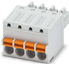
Leiterplattenstecker, Nennquerschnitt: 1,5 mm<sup>2</sup>, Farbe: lichtgrau, Nennstrom: 8 A, Bemessungsspannung (III/2): 160 V, Kontaktoberfläche: Sn, Kontaktart: Buchse, Anzahl der Potentiale: 4, Anzahl der Reihen: 1, Polzahl: 4, Anzahl der Anschlüsse: 4, Artikelfamilie: FK-MCP 1,5/...-ST, Rastermaß: 3,5 mm, Anschlussart: Push-in-Federanschluss, Anschlussrichtung Leiter/Platine: 0 °, Stecksystem: COMBICON MC 1,5, Verriegelung: ohne, Befestigungsart: ohne, Verpackungsart: verpackt im Karton
