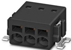
Leiterplattenklemme, Nennstrom: 6 A, Bemessungsspannung (III/2): 160 V, Nennquerschnitt: 0,5 mm<sup>2</sup>, Anzahl der Potenziale: 7, Anzahl der Reihen: 1, Polzahl pro Reihe: 7, Artikelfamilie: PTSM 0,5/...-H-SMD, Rastermaß: 2,5 mm, Anschlussart: Push-in-Federanschluss, Montage: SMD-Löten, Anschlussrichtung Leiter/Platine: 0 °, Farbe: schwarz, Pin-Layout: Lineare Pad-Geometrie, Anzahl der Lötpins pro Potenzial: 1, Verpackungsart: Gurt in 44 mm Breite
