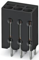
Leiterplattenklemme, Nennstrom: 6 A, Bemessungsspannung (III/2): 160 V, Nennquerschnitt: 0,5 mm<sup>2</sup>, Anzahl der Potenziale: 7, Anzahl der Reihen: 1, Polzahl pro Reihe: 7, Artikelfamilie: PTSM 0,5/..-V-THR, Rastermaß: 2,5 mm, Anschlussart: Push-in-Federanschluss, Montage: THR-Löten / Wellenlöten, Anschlussrichtung Leiter/Platine: 90 °, Farbe: schwarz, Pin-Layout: Lineares Pinning, Pinlänge [P]: 2,1 mm, Anzahl der Lötpins pro Potenzial: 2, Verpackungsart: Gurt in 44 mm Breite
