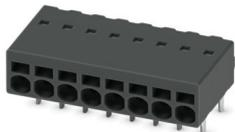
Leiterplattenklemme, Nennstrom: 6 A, Bemessungsspannung (III/2): 160 V, Nennquerschnitt: 0,5 mm<sup>2</sup>, Anzahl der Potentiale: 8, Anzahl der Reihen: 1, Polzahl pro Reihe: 8, Artikelfamilie: PTSM 0,5/..-H-THR, Rastermaß: 2,5 mm, Anschlussart: Push-in-Federanschluss, Montage: THR-Löten / Wellenlöten, Anschlussrichtung Leiter/Platine: 0 °, Farbe: schwarz, Pin-Layout: Lineares Pinning, Pinlänge [P]: 2,1 mm, Anzahl der Lötpins pro Potenzial: 2, Verpackungsart: Gurt in 32 mm Breite
