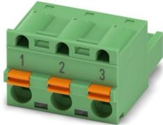
Leiterplattenstecker, Nennquerschnitt: 2,5 mm<sup>2</sup>, Farbe: grün, Nennstrom: 12 A, Bemessungsspannung (III/2): 630 V, Kontaktoberfläche: Sn, Kontaktart: Buchse, Anzahl der Reihen: 1, Polzahl: 3, Anschlussart: Push-in-Federanschluss, Anschlussrichtung Leiter/Platine: 0 °, Rasthaken: - Rasthaken, Stecksystem: COMBICON MSTB 2,5, Verriegelung: ohne, Befestigungsart: ohne, Verpackungsart: verpackt im Karton
