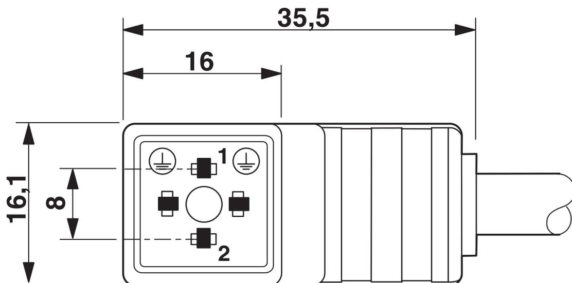
Ventilstecker, Bauform C
