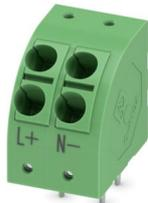
Leiterplattenklemme, Nennstrom: 24 A, Bemessungsspannung (III/2): 400 V, Nennquerschnitt: 2,5 mm<sup>2</sup>, Anzahl der Reihen: 1, Polzahl pro Reihe: 2, Anschlussart: Push-in-Federanschluss, Montage: Wellenlöten, Anschlussrichtung Leiter/Platine: 45 °, Farbe: grün, Pin-Layout: Lineares Pinning, Pinlänge [P]: 3,5 mm, Anzahl der Lötpins pro Potenzial: 2, Verpackungsart: verpackt im Karton
