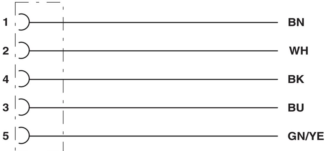
Kontaktbelegung der M12-Buchsen
