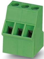
Leiterplattenklemme, Nennstrom: 20 A, Bemessungsspannung (III/2): 400 V, Nennquerschnitt: 2,5 mm<sup>2</sup>, Anzahl der Reihen: 1, Polzahl pro Reihe: 2, Artikelfamilie: SMKDS 2,5, Rastermaß: 5,08 mm, Anschlussart: Schraubanschluss mit Zughülse, Schraubenangriffsform: L Längsschlitz, Montage: Wellenlöten, Anschlussrichtung Leiter/Platine: 50 °, Farbe: orange, Pin-Layout: Lineares Pinning, Pinlänge [P]: 3,5 mm, Anzahl der Löt pins pro Potenzial: 1, Verpackungsart: verpackt im Karton
