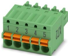
Leiterplattenstecker, Nennquerschnitt: 1,5 mm<sup>2</sup>, Farbe: grün, Nennstrom: 8 A, Bemessungsspannung (III/2): 160 V, Kontaktoberfläche: Sn, Kontaktart: Buchse, Anzahl der Reihen: 1, Polzahl: 5, Artikelfamilie: FK-MCP 1,5/..-ST, Rastermaß: 3,5 mm, Anschlussart: Push-in-Federanschluss, Anschlussrichtung Leiter/Platine: 0 °, Stecksystem: COMBICON MC 1,5, Verriegelung: ohne, Befestigungsart: ohne, Verpackungsart: verpackt im Karton
