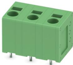
Leiterplattenklemme, Nennstrom: 22 A, Nennquerschnitt: 2,5 mm<sup>2</sup>, Anzahl der Reihen: 1, Polzahl pro Reihe: 3, Artikelfamilie: SPT 2,5/..-V-EX, Rastermaß: 5 mm, Anschlussart: Push-in-Federanschluss, Montage: Wellenlöten, Anschlussrichtung Leiter/Platine: 90 °, Farbe: grün, Pin-Layout: Lineares Pinning, Pinlänge [P]: 2,5 mm, Anzahl der Lötpins pro Potenzial: 2, Verpackungsart: verpackt im Karton
