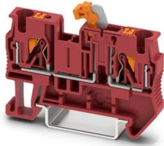
Messertrennklemme, Nennspannung: 500 V, Nennstrom: 20 A, Anschlussart: Push-in-Anschluss, Bemessungsquerschnitt: 4 mm<sup>2</sup>, Querschnitt: 0,2 mm<sup>2</sup> - 6 mm<sup>2</sup>, Montage: NS 35/7,5, NS 35/15, Farbe: rot
