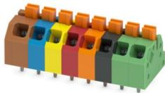
Leiterplattenklemme, Nennstrom: 16 A, Bemessungsspannung (III/2): 160 V, Nennquerschnitt: 1,5 mm<sup>2</sup>, Anzahl der Reihen: 1, Polzahl pro Reihe: 8, Artikelfamilie: SPTAF 1/..-EL, Rastermaß: 3,5 mm, Anschlussart: Push-in-Federanschluss, Montage: Wellenlöten, Anschlussrichtung Leiter/Platine: 45 °, Farbe: mehrfarbig, Pin-Layout: Lineares Pinning, Pinlänge [P]: 2,6 mm, Anzahl der Lötpins pro Potenzial: 2, Verpackungsart: verpackt im Karton
